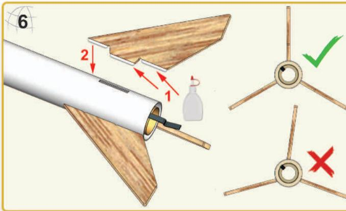
**DE** Etwas Holzleim entlang der Wurzel und Lasche einer Flosse auftragen und durch einen Schlitz im Körperrohr stecken. Darauf achten, dass jede Flosse gut aufsitzt und zwecks guter Haftung im korrekten Winkel zum Rohr aufgeklebt wird. Mit jeder Flosse wiederholen. Klebstoff trocknen lassen.
