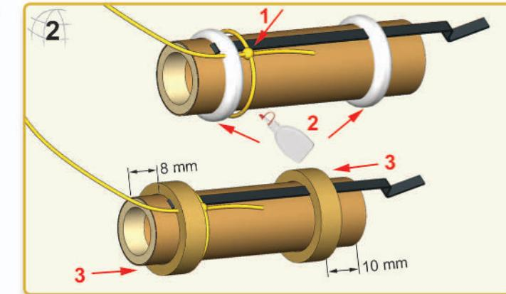
Das kurze Ende vom Motorhaltebügel in den Schlitz des Motorrohrs drücken.
