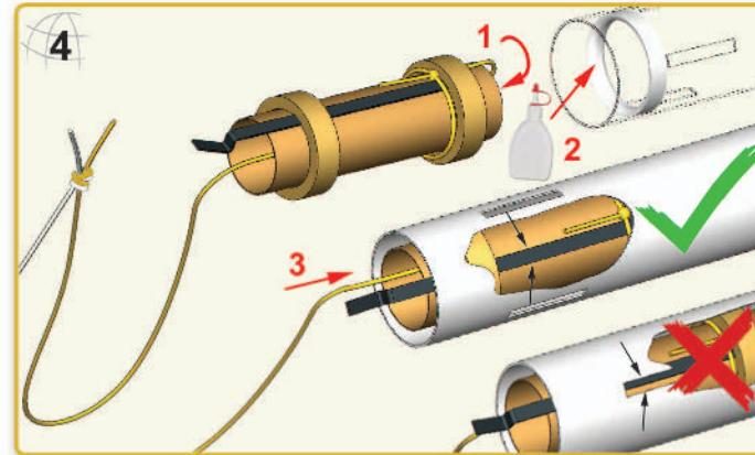
**Deutsch** Das Schockband durch die Motorhalterung nach hinten ziehen. Innen im Körperrohr eine Raupe mit Klebstoff auftragen.
