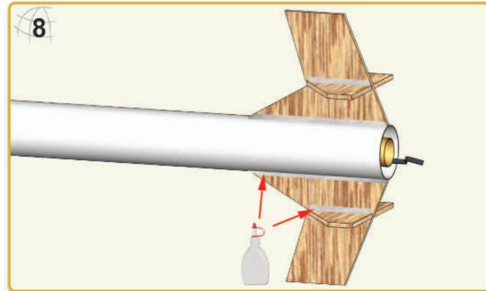
**Germany** Wenn der Klebstoff überall getrocknet ist, eine kleine Raupe mit Klebstoff in alle Fugen auftragen und mit einer feuchten Fingerkuppe glätten. Überschüssigen Klebstoff mit einem Papiertuch abwischen.
