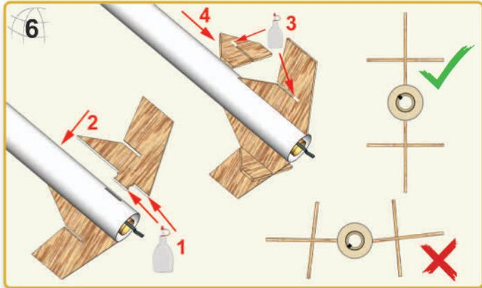
**Germany** Etwas Holzleim entlang der Wurzel und Lasche der Flügel auftragen und durch die Schlitze im Körperrohr stecken. Darauf achten, dass die Flügel gut aufsitzen und zwecks guter Haftung im rechten Winkel zum Rohr aufgeklebt werden. Die Ruder wie abgebildet ankleben. Klebstoff trocknen lassen.
