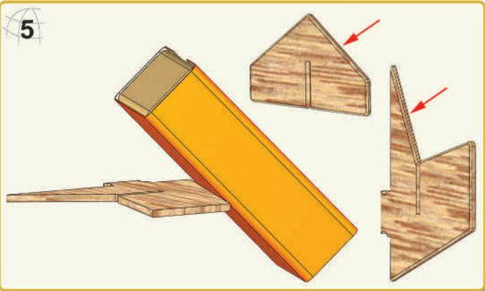
**Germany** An dieser Stelle kann man entscheiden ob die Kanten eckig bleiben, gerundet werden, eine Fase, oder sogar eine Stromlinienform erhalten. Am besten geht es mit einem Schleifklotz.
