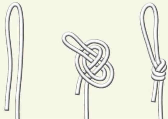
In das elastische Schockband an beiden Enden eine Schlaufe binden.
