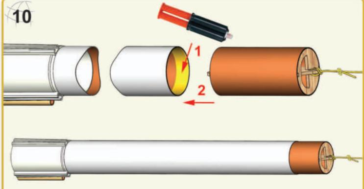
Den fertigen Fallschirmschutz im unteren Körperrohr wie abgebildet einkleben, jedoch nur zur Hälfte einschieben.
