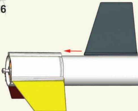
Die Flossen entsprechend der konischen Führung bis zum Anschlag in die Nuten des Heckteils stecken. Klebstoff wird nicht benötigt.
