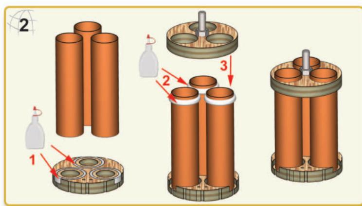
Am vorderen Motorspant wie abgebildet Klebstoff (Holzleim) auftragen und Motorrohre aufstecken. Am hinteren Ende der Motorrohre umlaufend Klebstoff auftragen und den hinteren Spant ankleben. Der Spant sollte bündig mit diesen sein, bzw. sollten die Motorrohre maximal 3mm überstehen. Anschließend von beiden Seiten eine umlaufende Klebstoff-Raue anbringen und zum Trocknen beiseitelegen.
