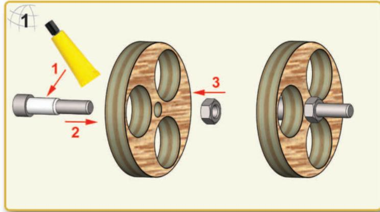
Etwas Klebstoff (Epoxidharz) auf die Schraube auftragen und durch das Loch des hinteren Motorspants stecken. Mutter anschrauben und fest anziehen.
