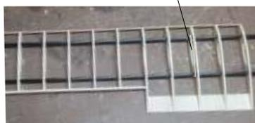
Wir fliegen die RAK1 ohne Streben, es besteht aber optional die Möglichkeit diese anzubringen. Dafür werden die abgebildeten Teile nach Zusammenbau der Tragfläche in die 3. Rippe von innen eingeschoben.
