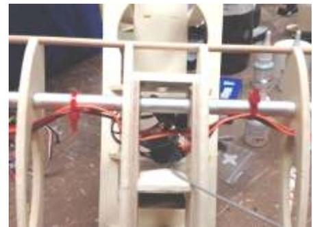
Servos verkabeln und auf Nullpunkt bringen, am besten hier die beiden V-Kabel einsetzen
