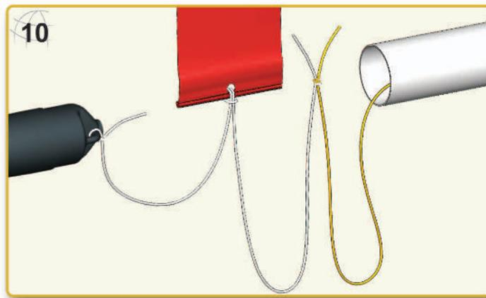
**DE** Das freie Ende der Gummischnur wird jetzt an der Öse der Raketenspitze mit einem Doppelknoten befestigt. Sollte sich noch ein Kunststoffrest in der Öse befinden, kann dieser mit einem Kuli oder Metallstift problemlos herausgedrückt werden.
