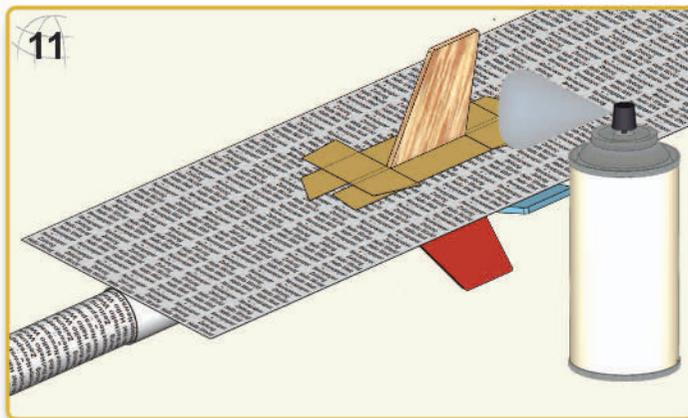
**DE** Das Modell abschleifen, grundieren und entweder wie auf der Verpackung vorgeschlagen oder nach eigener Vorliebe lackieren. Die Flossen mit Kreppband und Zeitungspapier abdecken um sie in separaten Farben zu lackieren.
