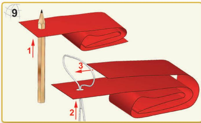
**DE** Mit einem spitzen Gegenstand sollte ca. 20 mm von einem Ende des Strömers ein Loch durchgestoßen werden. Das elastische Schockband zu einer Schlaufe formen und das andere Ende des Strömers wie abgebildet hindurch ziehen.
